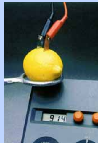
Αυτοσχέδιο γαλβανικό στοιχείο με τη βοήθεια ενός λεμονιού και δύο συρμάτων Zn, Cu. Το δυναμικό αυτού του στοιχείου είναι περίπου 914 mV.
