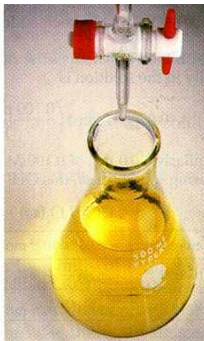
ΣΧΗΜΑ 1.18 Κατά την ογκομέτρηση της ασθενούς βάσης \text{NH}_3 με πρότυπο διάλυμα \text{HCl} η αλλαγή του χρώματος του ερυθρού του μεθυλίου από κίτρινο σε κόκκινο πιστοποιεί το τέλος της ογκομέτρησης (ισοδύναμο σημείο).
