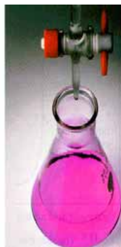
ΣΧΗΜΑ 1.16 Κατά την ογκομέτρηση οξέος (άγνωστο) με πρότυπο διάλυμα \text{NaOH} η αλλαγή του χρώματος της φαινολοφθαλείνης από άχρωμο σε κόκκινο πιστοποιεί το τέλος της ογκομέτρησης (ισοδύναμο σημείο).
