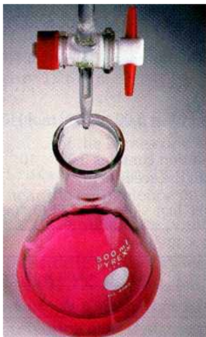
ΣΧΗΜΑ 1.18 Κατά την ογκομέτρηση της ασθενούς βάσης \text{NH}_3 με πρότυπο διάλυμα \text{HCl} η αλλαγή του χρώματος του ερυθρού του μεθυλίου από κίτρινο σε κόκκινο πιστοποιεί το τέλος της ογκομέτρησης (ισοδύναμο σημείο).
