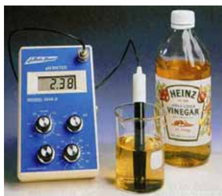
ΣΧΗΜΑ 1.9 Προσδιορισμός της τιμής pH με πεχάμετρο σε: α. γάλα της μαγνησίας - διάλυμα Mg(OH)_2 β. ξύδι - διάλυμα CH_3COOH .
