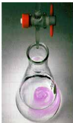
ΣΧΗΜΑ 1.16 Κατά την ογκομέτρηση οξέος (άγνωστο) με πρότυπο διάλυμα \text{NaOH} η αλλαγή του χρώματος της φαινολοφθαλείνης από άχρωμο σε κόκκινο πιστοποιεί το τέλος της ογκομέτρησης (ισοδύναμο σημείο).
