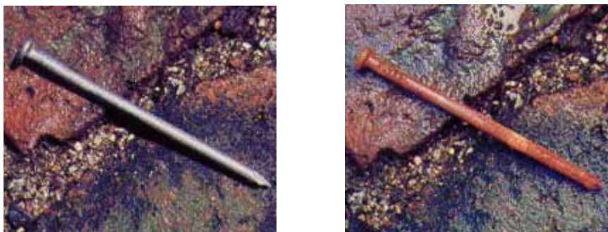
ΣΧΗΜΑ 2.8 Το σκούριασμα του σιδήρου γίνεται αυθόρμητα, επειδή η αντίδραση είναι εξώθερμη. Η αντίστροφη αντίδραση δεν είναι αυθόρμητη.
