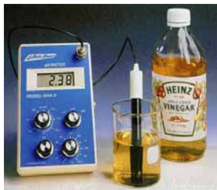
ΣΧΗΜΑ 3.9 Προσδιορισμός της τιμής pH με πεχάμετρο σε: α. γάλα της μαγνησίας - διάλυμα Mg(OH)_2 β. ξύδι - διάλυμα CH_3COOH .
