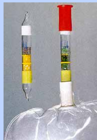
Αλκοτέστ μπορεί να γίνει με βάση την αλλαγή χρώματος που προκαλεί η οξείδωση της αλκοόλης σε \text{K}_2\text{Cr}_2\text{O}_7 (από πορτοκαλί σε πράσινο).
