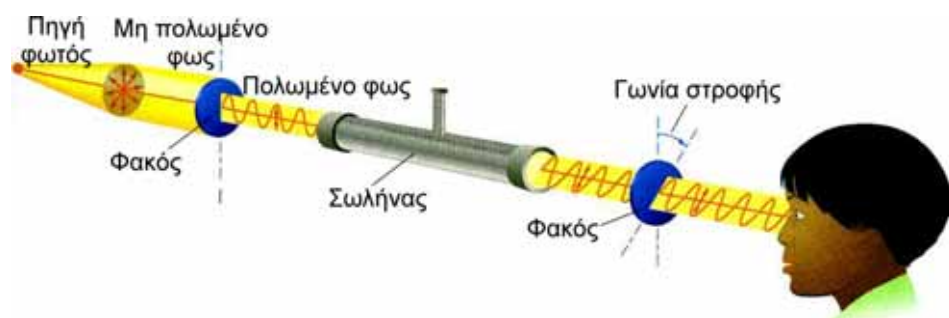
ΣΧΗΜΑ 5.21 Σχηματική παρουσίαση ενός πολωσίμετρου. Η οπτικά ενεργή ουσία στρέφει το επίπεδο του πολωμένου φωτός.
