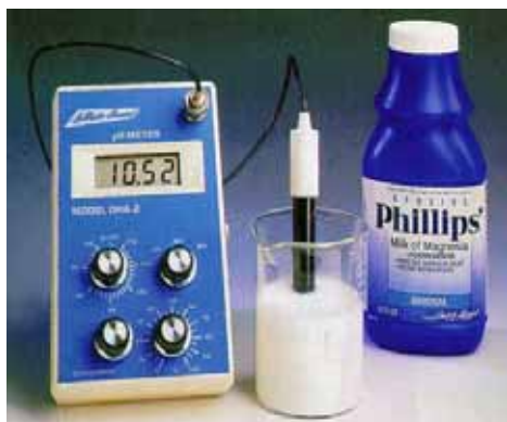
ΣΧΗΜΑ 3.9 Προσδιορισμός της τιμής pH με πεχάμετρο σε: α. γάλα της μαγνησίας - διάλυμα Mg(OH)_2 β. ξύδι - διάλυμα CH_3COOH .
