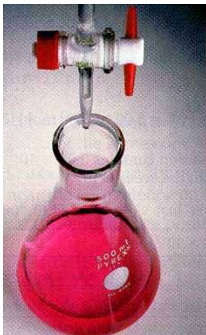
ΣΧΗΜΑ 3.18 Κατά την ογκομέτρηση της ασθενούς βάσης \text{NH}_3 με πρότυπο διάλυμα \text{HCl} η αλλαγή του χρώματος του ερυθρού του μεθυλίου από κίτρινο σε κόκκινο πιστοποιεί το τέλος της ογκομέτρησης (ισοδύναμο σημείο).
