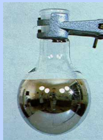
Οι αλδεΐδες αντιδρούν με το αντιδραστήριο Tollens και σχηματίζουν κάτοπτρο. Η αντίδραση αυτή χρησιμεύει για τη διάκριση μεταξύ αλδεϋδών και κετονών.
