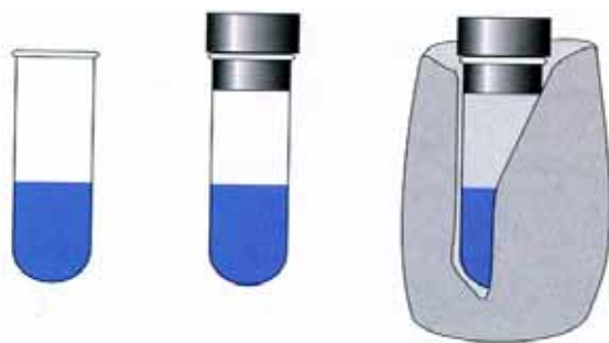
ΣΧΗΜΑ 2.1 Διάφοροι τύποι συστημάτων από αριστερά προς τα δεξιά: ανοικτό, κλειστό, αδιαβατικό κλειστό.
