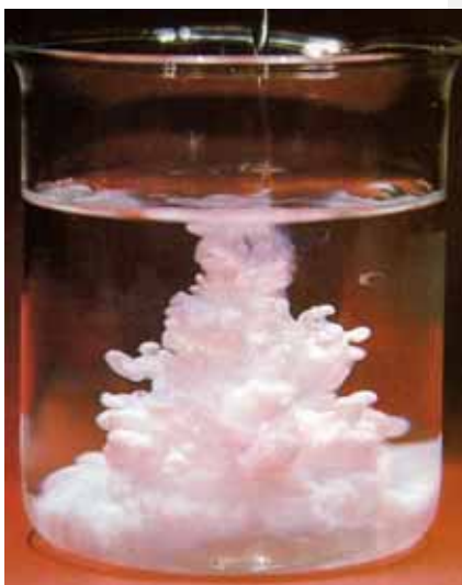
ΣΧΗΜΑ 3.21 α. Διαγραμματική απεικόνιση των συνθηκών κάτω από τις οποίες σχηματίζεται ίζημα AgCl β. σχηματισμός ιζήματος AgCl κατά την ανάμιξη διαλύματος AgNO 3 με διάλυμα NaCl
