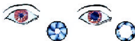
4-28 Το διάφραγμα και η ίριδα. Όταν έχουμε πολύ φωτισμό, το άνοιγμα είναι μικρό και, όταν έχουμε λίγο φωτισμό, το άνοιγμα είναι μεγάλο.
