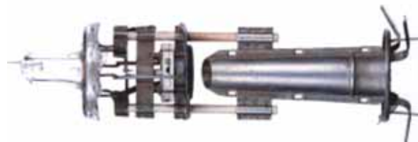
Εικ. 3.3 Τηλεβόλο ηλεκτρονίων.
