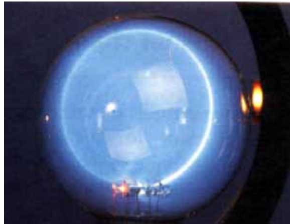
Εικ 4.8 Πειραματική διάταξη για τη μελέτη της εκτροπής μιας δέσμης ηλεκτρονίων μέσα σε μαγνητικό πεδίο. Το μαγνητικό πεδίο είναι κάθετο στη διεύθυνση κίνησης της δέσμης. Τα ηλεκτρόνια κινούνται κυκλικά.
