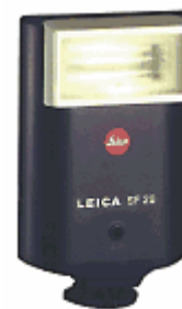
Εικ. 3.7 Η λειτουργία του φλας της φωτογραφικής μηχανής στηρίζεται στην εκφόρτιση ενός πυκνωτή δια μέσου μιας λυχνίας ξένου. Καθώς εκφορτίζεται ο πυκνωτής το αέριο ξένο ιονίζεται με αποτέλεσμα την έντονη αναλαμπή μικρής διάρκειας.
